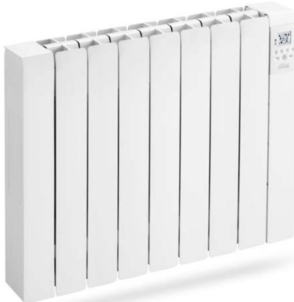
**Emisor térmico de fluido entre 3 y 9 elementos de 500 a 1.500 W de potencia. Tecnología INVERTER (mediante PID+TRIAC) con ahorros de hasta un 30% frente a modelos tradicionales. Realiza el calentamiento a través de fluido caloportador que permite que el calor se mantenga durante más tiempo en el radiador.**
